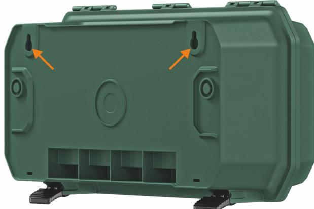
2. Befestigung des Produkts an der Wand durch Bohren des Gehäuses und Verschrauben mit der Wand. Erforderliche Montage mit Dehnbolzen, M6-Schrauben und Flachdichtungen. Lochabstand 254mm.
